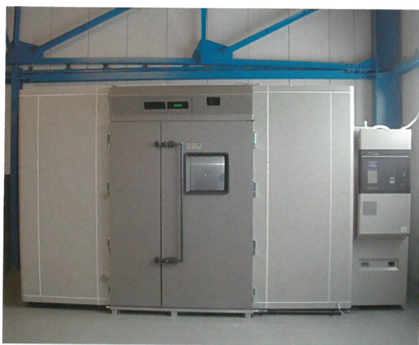
恒温室: 内寸法W3480×L1660×H2200mm・扉寸法W1400×H1835mm
